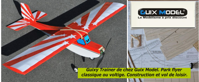
Avion ou motoplaneur électrique, les équipements sont similaires. L'hélice sera repliable pour le second afin d'améliorer les performances du vol plané.
